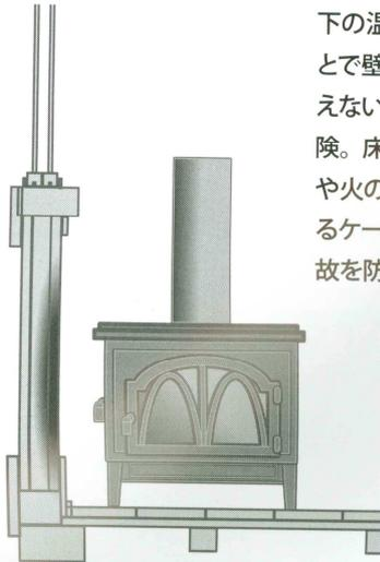
長時間、ある程度高温にさらされていると木材は、発火点以下でも炭化が進む。炭化が進むと発火点が下がり、ストーブの温度でも発火してしまう恐れがある
